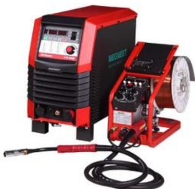
Artsen CM500C - это сварочный полуавтомат предназначенный специально для тех областей промышленности где сварщику необходима высокая мобильность, например, судостроение. Особенностью данной модели полуавтомата является возможность выносить подающий механизм на расстояние до 100 метров от источника. На устройстве подачи проволоки также имеется цифровая панель управления параметрами сварки, что существенно упрощает процесс работы.
